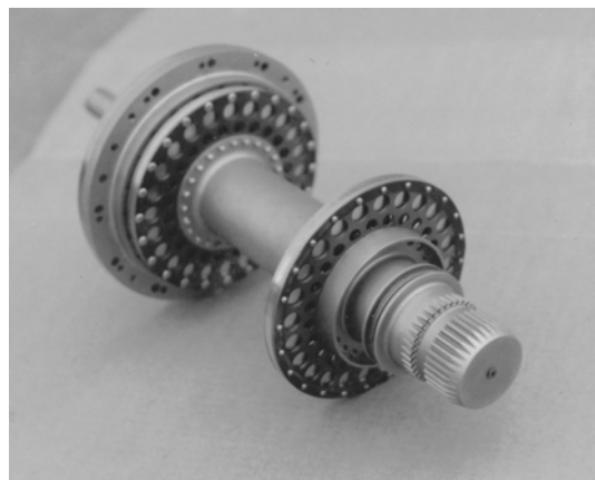
右图：162号CC型富来克索联轴器，用于燃气轮机，由Inconel制成，1500马力，24000转/每分钟。
